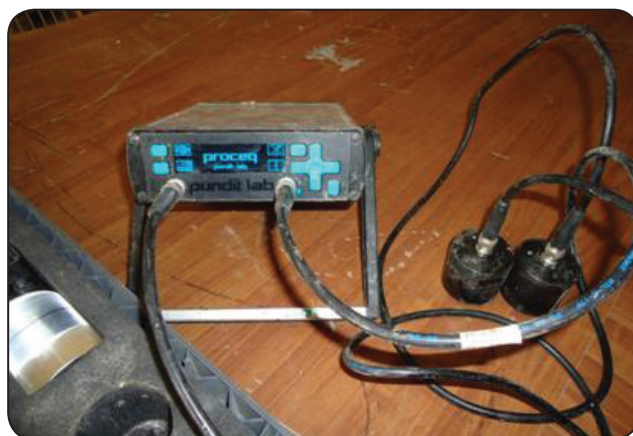
شكل (2): الجهاز المستخدم لقياس سرعة الأمواج فوق الصوتية
