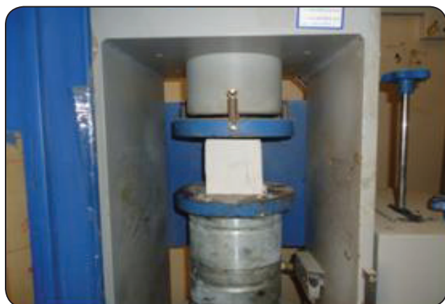
شكل (4): فحص مقاومة الانضغاط لمكعبات الترمستون
